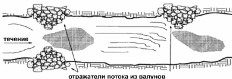
Рис. 7.61. Валунные отражатели потока, создающие удобные места обитания (Flosi et. al., 1998).
