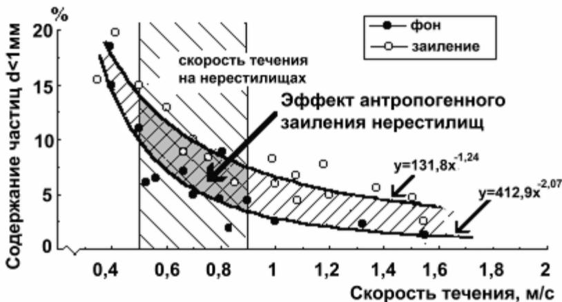
Рис. 4.8. Зависимость содержания в грунте частиц  $< 1 \text{ мм}$  от скорости течения на участках русла разной степени заиленности (Леман и др., 2000).
